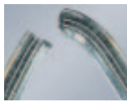
单芯光纤过度弯曲容易折断。
